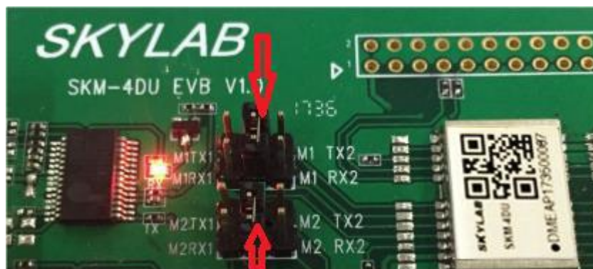
图 1-2 TX,RX 短接示意图
